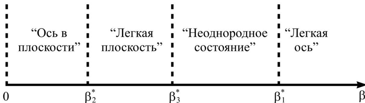
**Рис. 3.2.** Фазовая диаграмма ультратонкой магнитной пленки с конкурирующими одноионной и обменной анизотропиями и «плоским» магнитоупругим взаимодействием.
